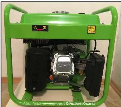
Notstromaggregate mit Verbrennungsmotor sollten aus Sicherheitsgründen niemals in geschlossenen Räumen verwendet werden. Es besteht Lebensgefahr! Menschen im Umkreis droht eine akute CO-Vergiftung.
